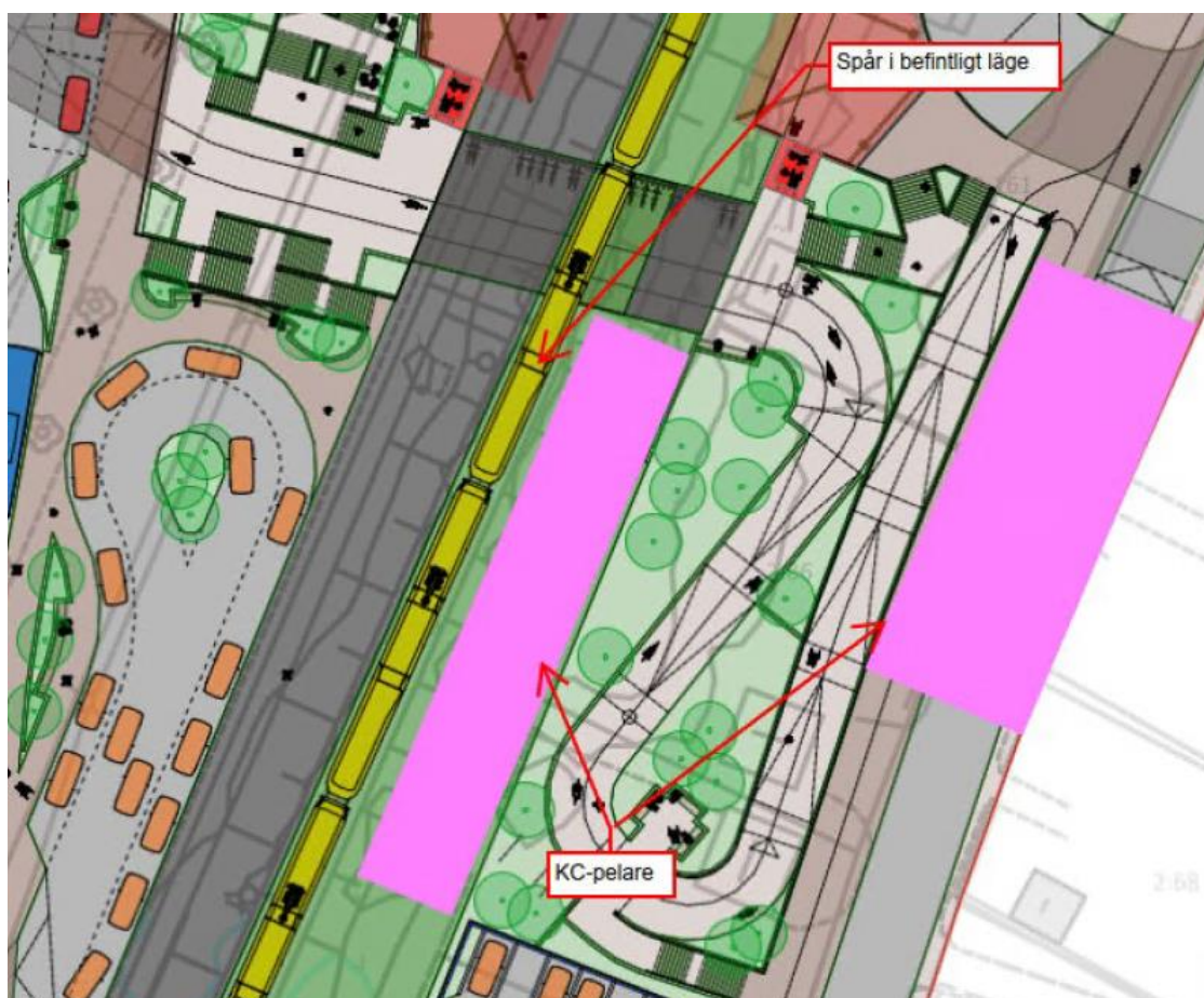
Illustration från Tekniskt PM Geoteknik (rev. D) av WSP som visar de områden där risk för stabilitetsproblem finns vid utbyggnad av planförslaget. Dessa områden redovisas med rosa färg.
