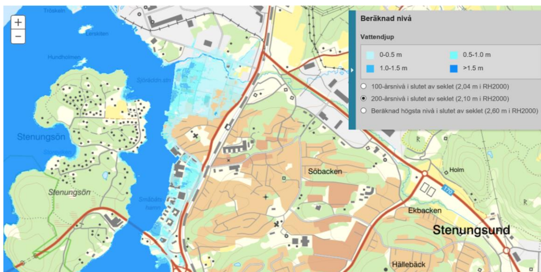
Beräknad 200-årsnivå för Stenungsund i slutet av seklet (+2,10 m.ö.h. i RH2000). Beräknat vattendjup.
